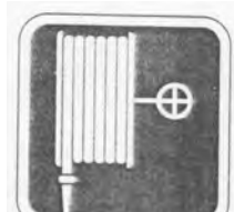
شلنگ اطفای حریق
