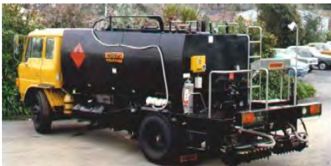
شکل شماره ۲-۲۰-۴- ماشین قیرپاش همراه تریلی
