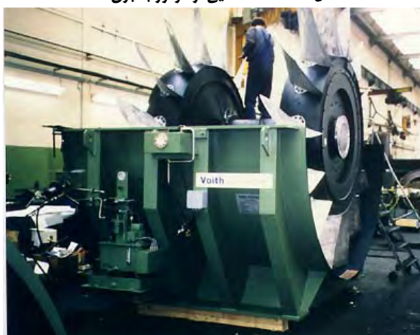
شکل ۶-۱۴-۶- بادبزن محوری دو طبقه در معدن زغال در آلمان، قطر پره ها ۳۲۰۰ میلی متر، قدرت موتور ۱۳۰۰ کیلو وات
