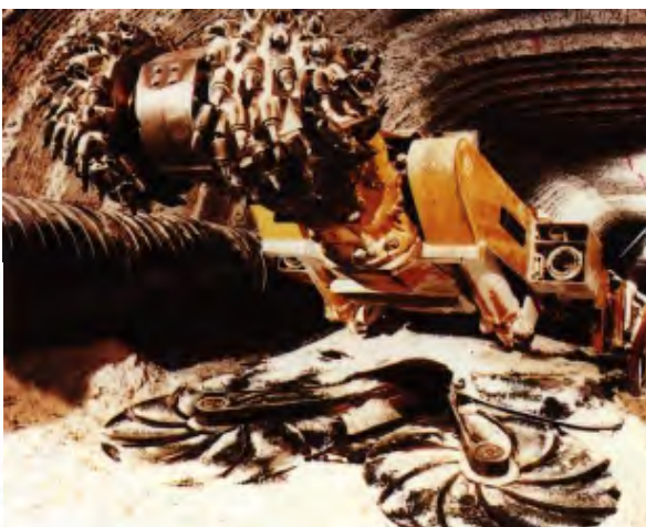
شکل ۳-۱۶-۱۵- ماشین رودهدر با دو صفحه ستاره‌دار دوار
