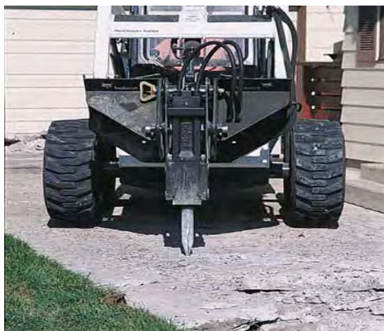
شکل ۲-۱۵-۳- چکش هیدرولیکی متصل به بابکت
