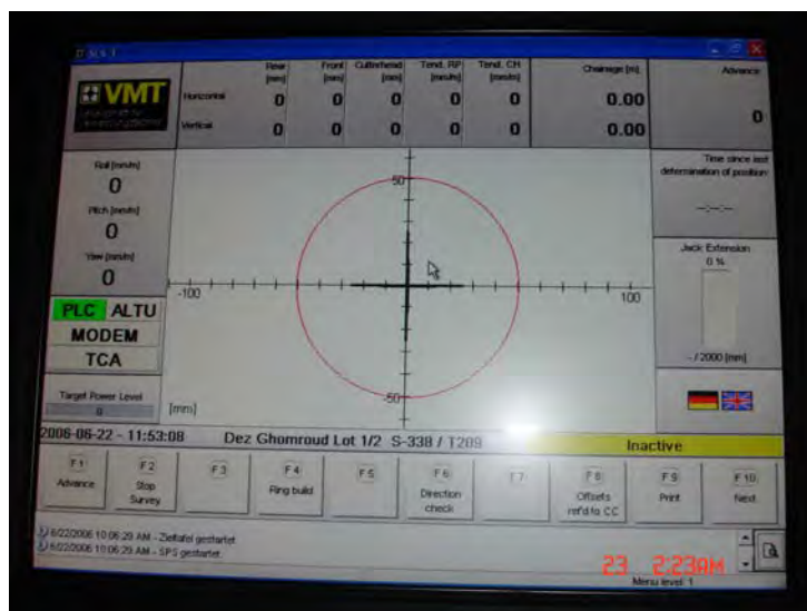
شکل ۳-۳-۳۶. صفحه اصلی نشاندهنده حرکت دستگاه در راستای مورد نظر که میزان انحراف را از مسیر که با ردیاب لیزری کنترل می‌شود، مشخص می‌کند.
