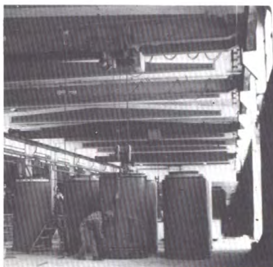
شکل ۴-۱۵-۷- جابه‌جا کردن لوله‌ها همراه با قالب محافظ
