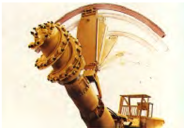
شکل ۳-۱۶-۷- ماشین رودهدر به همراه تجهیزات نصب قاب
