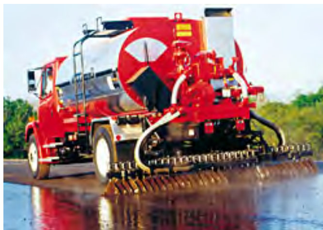
شکل شماره ۲-۲۰-۱- نمایی از ماشین قیرپاش
