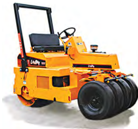
شکل ۲-۴-۹- غلتک پنوماتیک با قابلیت تغییر فشار باد لاستیک
