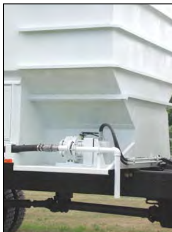
شکل ۳-۲۱-۱۳- پمپ انتقال گازوئیل
