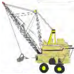
شکل شماره ۳-۱۲-۲- دراگلاین با شناسی چرخ لاستیکی
