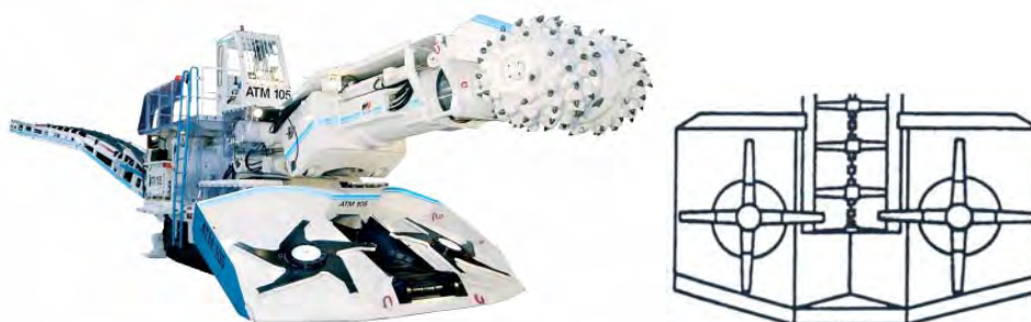
شکل ۳-۱۶-۱۴- ماشین رودهدر با صفحه پره دوار
