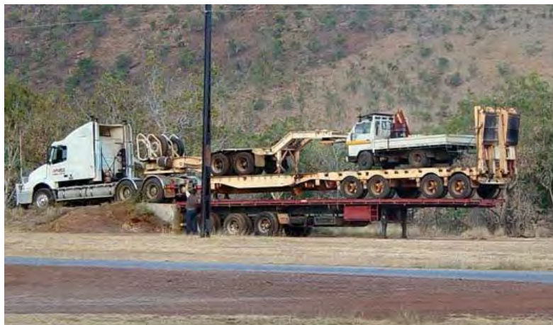
شکل ۳-۱۰-۶- کشنده در حال بار کردن کفی دارای شترگلو بر روی تریلی معمولی
