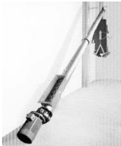
شکل ۴-۶-۴- پمپ هوا برای انتقال یخ با قیف توزین در انتها
