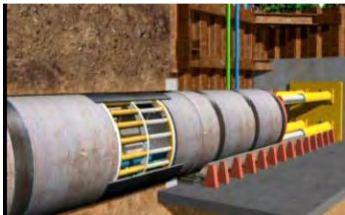
شکل ۵-۱۰-۹- ایستگاه جک های میانی
