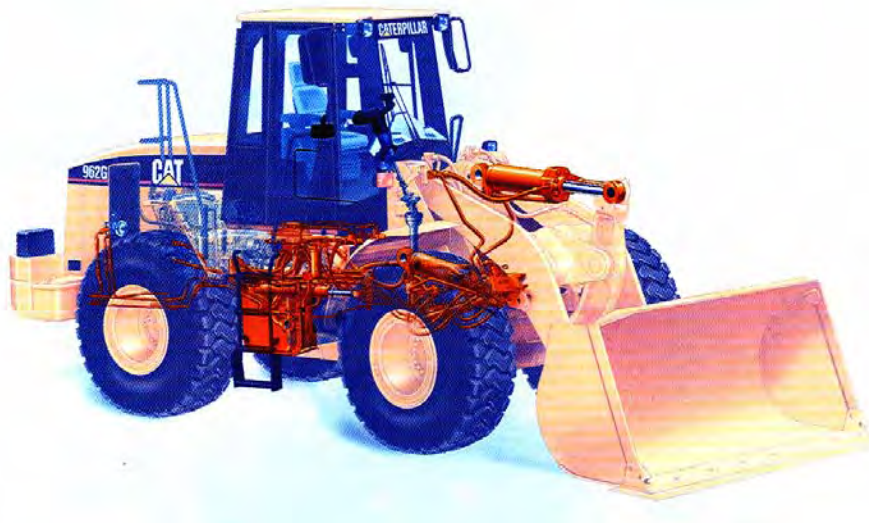
شکل شماره ۲-۱-۳- سیستم هیدرولیک یک نمونه لودر
