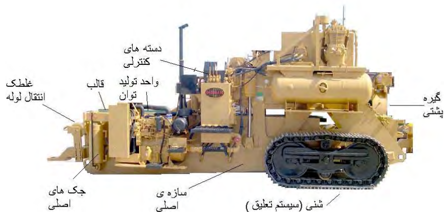
شکل ۴- اجزای اصلی یک دستگاه لوله خم کن
