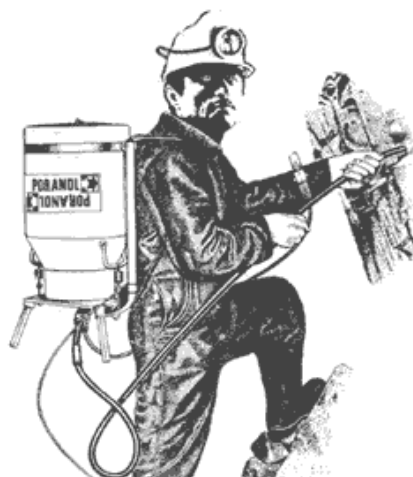
شکل ۳-۲۸-۱۲. نمونه آنفوشارژر قابل حمل به صورت انفرادی
