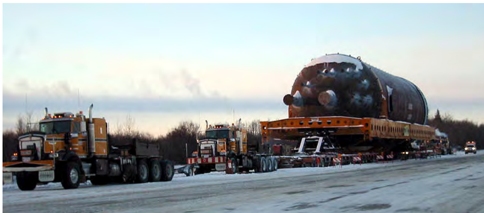
شکل ۳-۲-۶- استفاده از چند کشنده برای حمل بوژی
