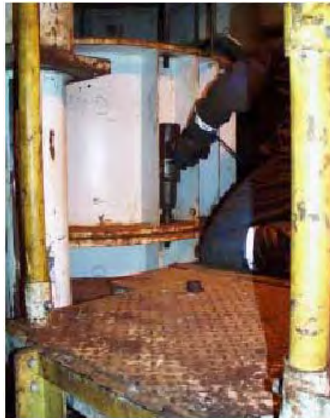
شکل ۳-۲۲-۱۵- نمایش اتصال کیسینگ‌ها به وسیله بولت
