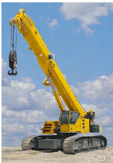
شکل ۶-۷-۱۲. نمونه جرثقیل چرخ زنجیری بوم تلسکوپی
