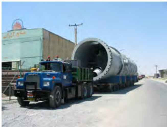
شکل ۶-۲-۱۴- استفاده از وزنه در انتهای بوژی کش برای کمک به شروع حرکت محموله
