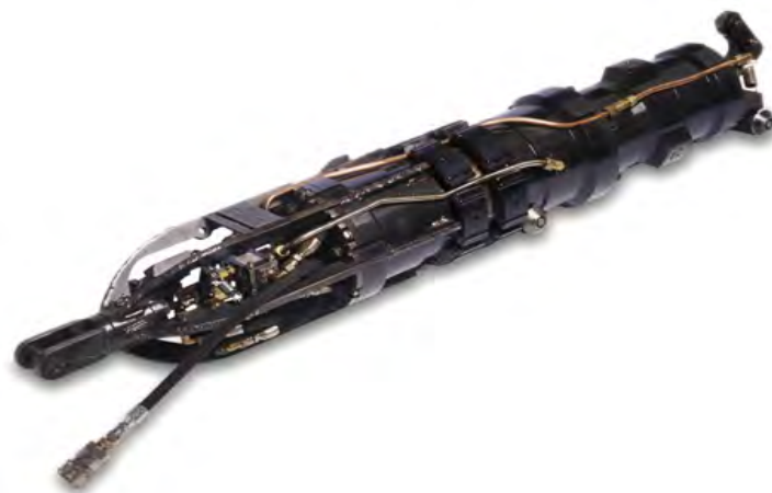
شکل ۵-۵-۱- نمونه ای از یک دستگاه کلمپ داخلی
