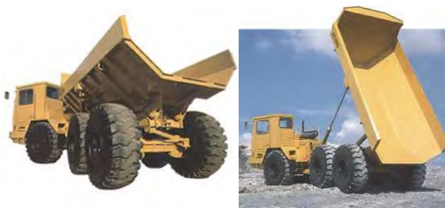
شکل ۲-۷-۵- کامیون کمرشکن در حال تخلیه
