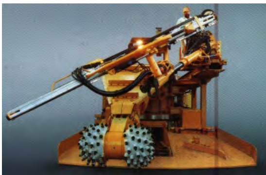
شکل ۳-۱۶-۶- ماشین رودهدر به همراه ماشین حفر چال بولت
