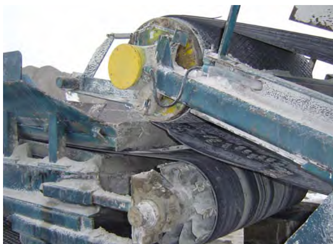
شکل ۶-۴-۸- طبلک محرکه و طبلک خلاص دو نوارنقاله مجزا
