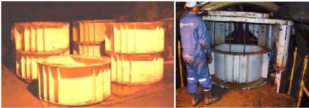
شکل ۳-۲۲-۱۴- نمایی از کیسینگ‌های استاندارد به طول ۸۰ سانتیمتر
