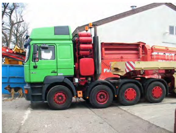
شکل ۶-۲-۲- بوژی کش با محور اضافی برای انتقال بهتر نیرو
