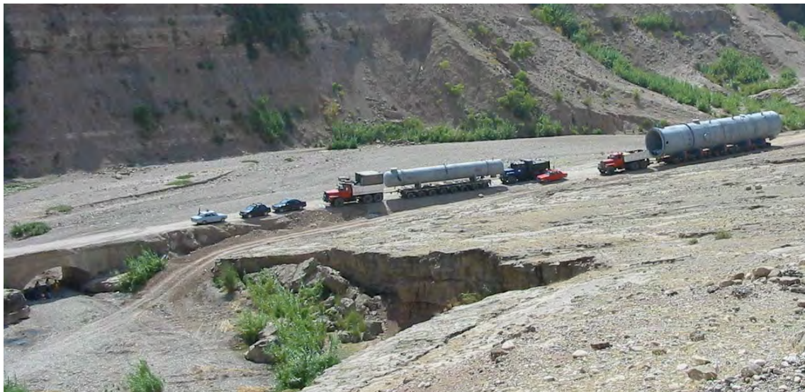
شکل ۶-۲-۱۰- عبور بوژی از کنار گذر پل
