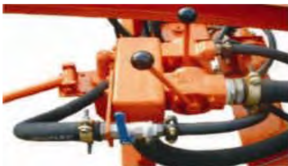
شکل ۳-۱۵-۷- تابلوی کنترل دستگاه این کنترل اتصالات چهار کاربرد عمده دارد: ضربه، دوران، جلوبرندگی و تراز کردن
