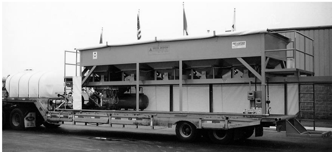
شکل شماره ۴-۳-۶- نمونه‌ای از یک بچینگ متحرک
