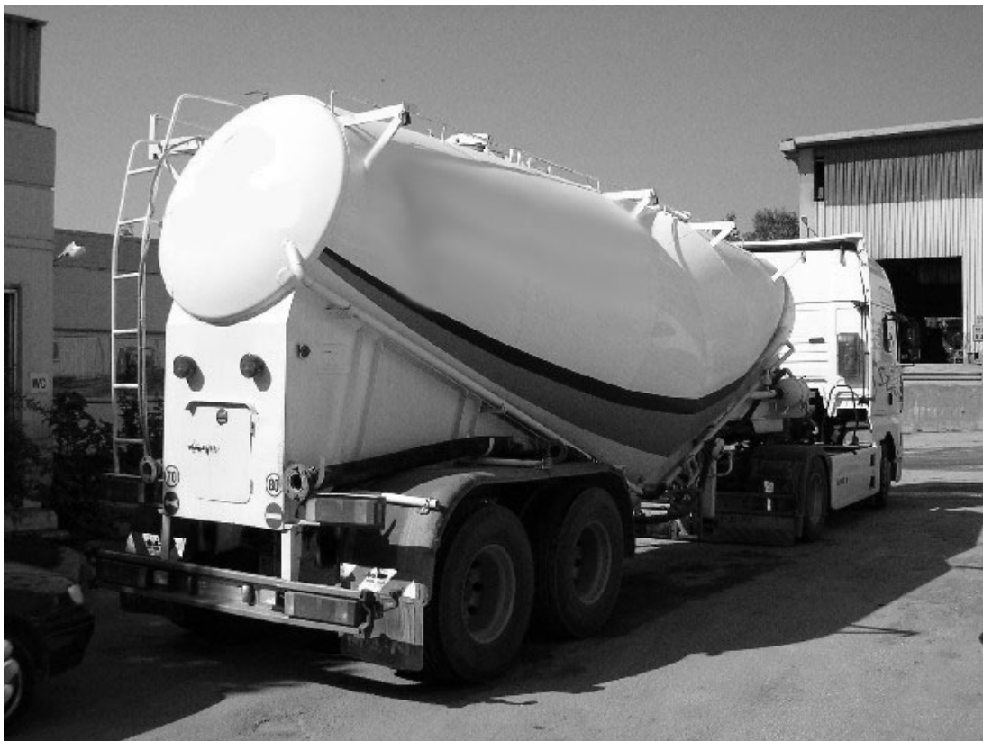
شکل ۴-۱۱-۱- نمونه از یک نوع بونکر سیمان با ظرفیت ۳۰ متر مکعب
