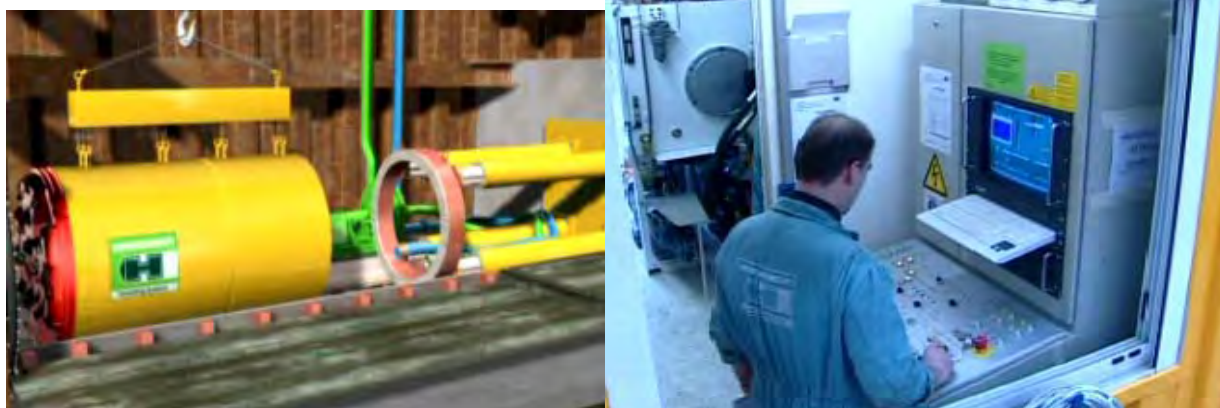
شکل ۹-۶-۱۴- تجهیزات کنترل سیستم
