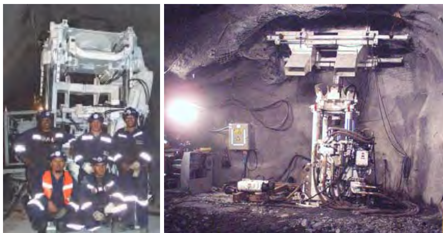
شکل ۳-۲۰-۱- نمونه‌ای از ماشین‌های حفاری جعبه‌ای
