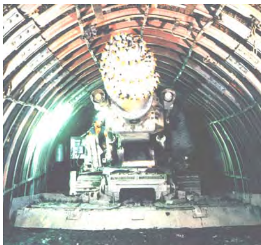
شکل ۳-۱۶-۳- ماشین روده‌در با برش محوری
