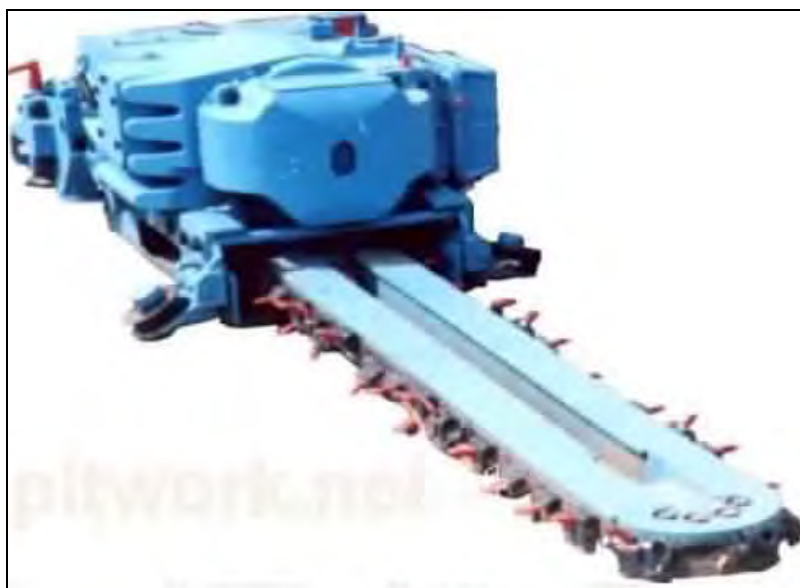
شکل ۳-۲۷-۱- نمونه ماشین هاواژ که در معادن زغالی به کار می‌رود
