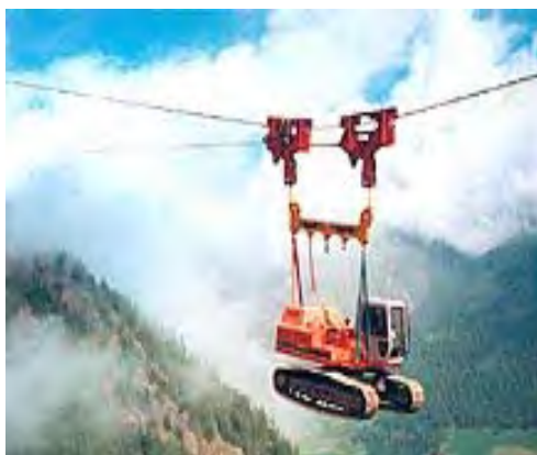
شکل ۶-۶-۱- جرثقیل کابلی در حال حمل بیل مکانیکی
