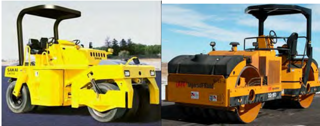
شکل ۲-۴-۶ و ۲-۴-۷- غلتک چرخ لاستیکی ارتعاشی (سمت چپ) و غلتک چرخ آهنی صاف ارتعاشی (سمت راست) ۴) غلتک‌های با چرخ فولادی صاف
