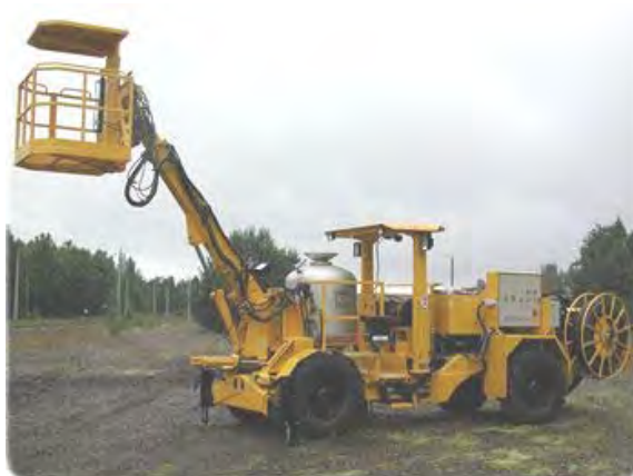
شکل ۳-۲۸-۹. نمونه دستگاه انفوشارژر، دارای سیستم محرکه، دکل و سبد
