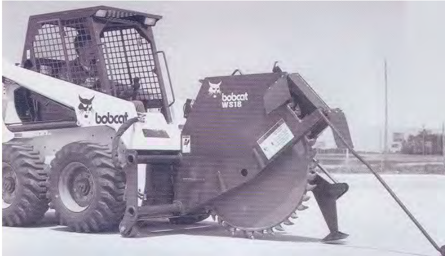
شکل ۲-۱۴-۲- بابکت تجهیز شده برای برش آسفالت
