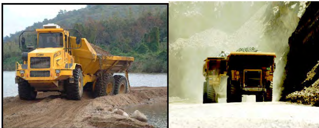
شکل شماره ۲-۱-۷-۲- انواع از انواع مختلف کامیون (غیر جاده‌ای و غیر جاده‌ای کمرشکن)
