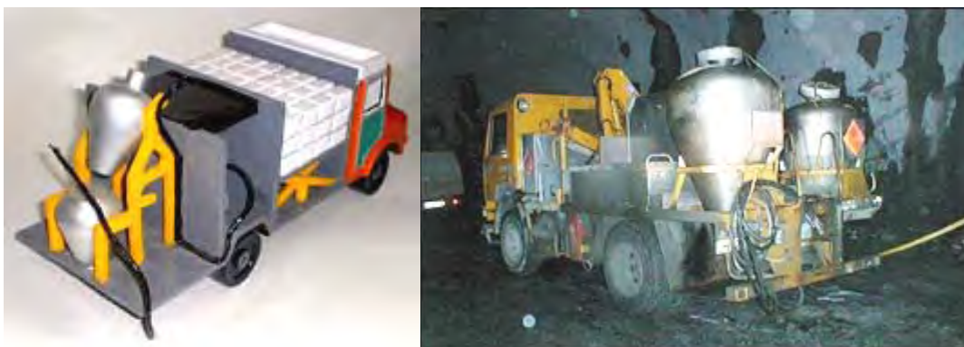
شکل ۳-۲۸-۸. نمونه دستگاه انفوشارژر، نصب شده روی کامیون
