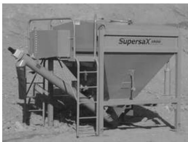
شکل ۴-۷-۲- نمونه ای از یک سیلوی کوچک برای کارهای کم حجم
