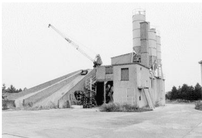
شکل ۴-۴-۳- درآگ لاین در حال انتقال سنگدانه به مخزن بچینگ
