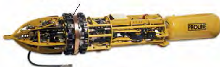
شکل ۵-۵-۴- کلمپ داخلی با صفحه کمکی مسی
