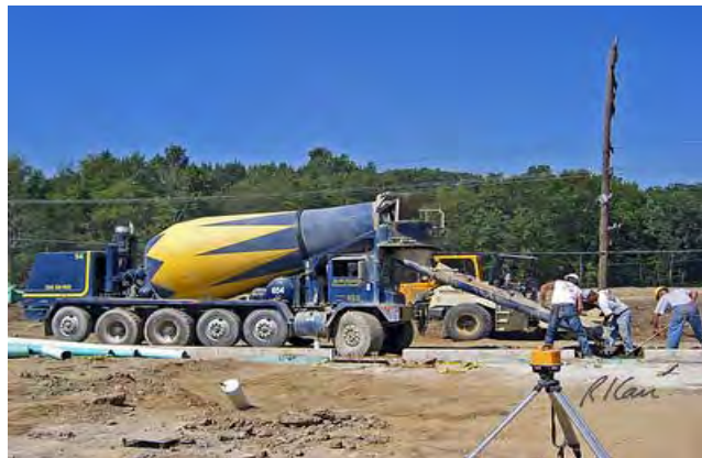
شکل ۴-۹-۱- تراک میکسر تخلیه از جلو سوار بر کامیون ۱۰ چرخ در حالی که سه محور اضافی آن مشاهده می شود. در شکل یدک کش موتور و سایر ملحقات مخزن در انتهای ماشین دیده می شود.
