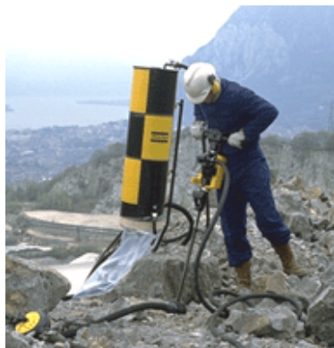
شکل ۳-۷-۵- نمایی از تجهیزات پرفراتور هوای فشرده (کمپرسور، سیستم روغن کاری، سیستم جداکننده آب، سیستم گردگیر و پرفراتور)
