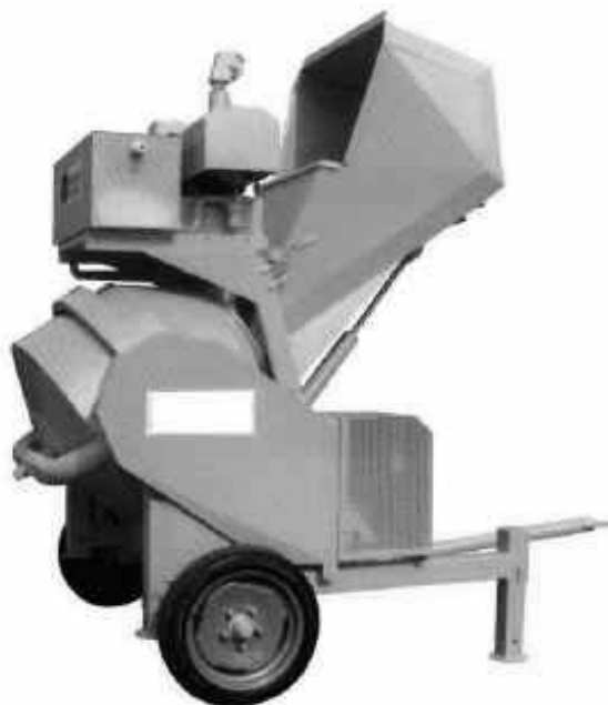
شکل ۴-۱۳-۵- بتونیر با محور متحرک دارای قیف تغذیه
