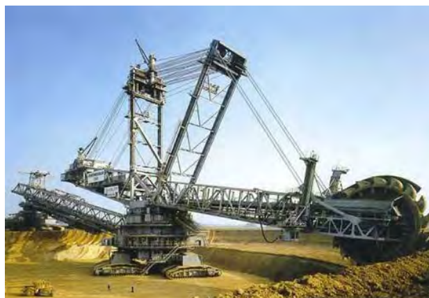
شکل ۳-۳۰-۲- نمایی از اسکویپتور با ۱۳۰۰۰ تن وزن که تنها در معدن استفاده می‌شود.
