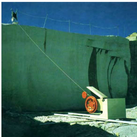
شکل ۳-۱۷-۱- برش سنگ با استفاده از دستگاه سیم برش
