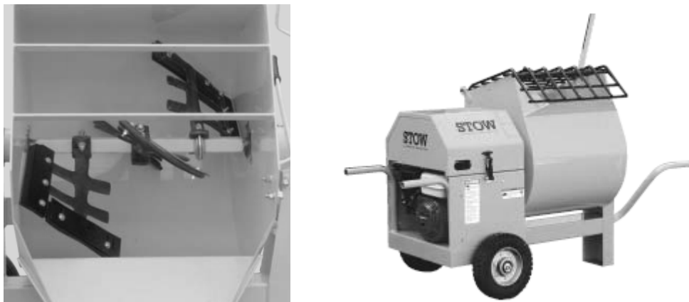
شکل ۴-۱۳-۶- یک دستگاه تولید ملات سیمان، در سمت چپ نمایی از پره‌های موجود در مخزن دیده می‌شود.
