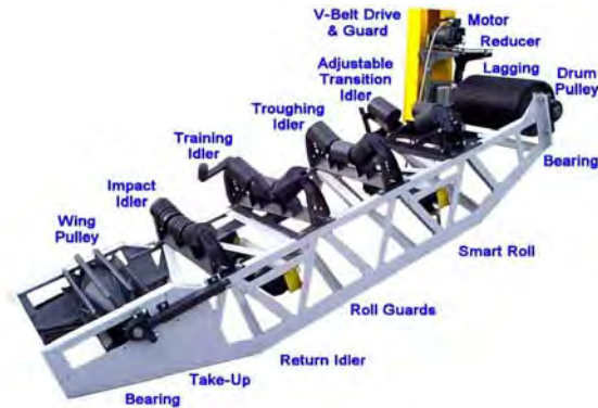
شکل ۶-۴-۴- دو نمای کلی از تجهیزات نوارنقاله
