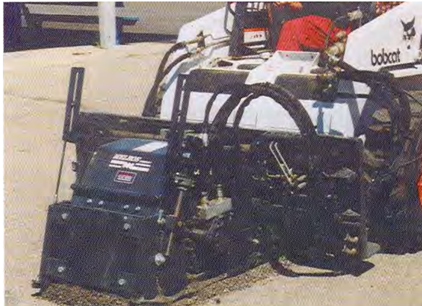
شکل ۲-۱۴-۱-۱- باب‌کت تجهیز شده برای تراش آسفالت
