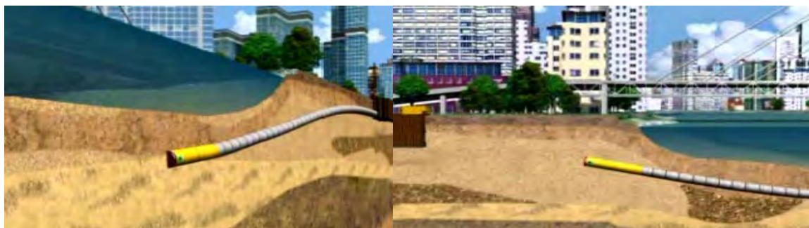
شکل ۵-۱۰-۲- نمایش مسیر لوله رانی از زیر رودخانه
