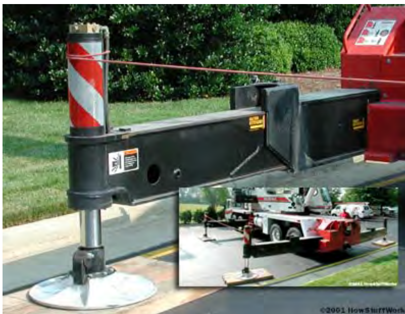
شکل ۶-۷-۷- جک (Outtrigger) در جرثقیلهای چرخ لاستیکی
