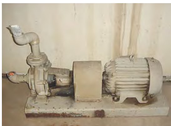
شکل ۶-۱۱-۳- یک پمپ سانتریفوژ متصل به الکتروموتور
