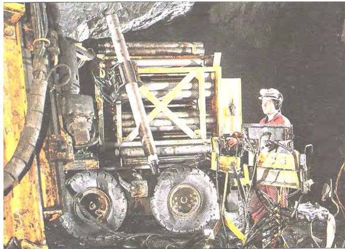
شکل ۳-۱۸-۵- نمایش سیستم جایجایی اتوماتیک لوله‌های حفاری
