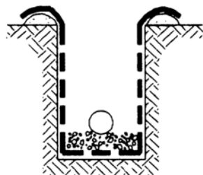
۳- اجرای مصالح زیرین و نصب لوله
