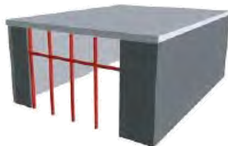
الف- اضافه کردن دیوارهای سازه‌ای
