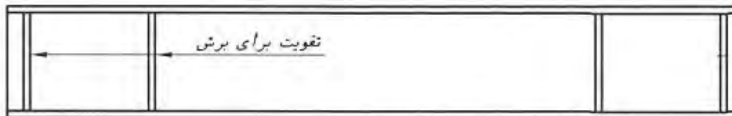
شکل ۲-۴-۲- اضافه نمودن ورق‌های سخت کننده عرضی
