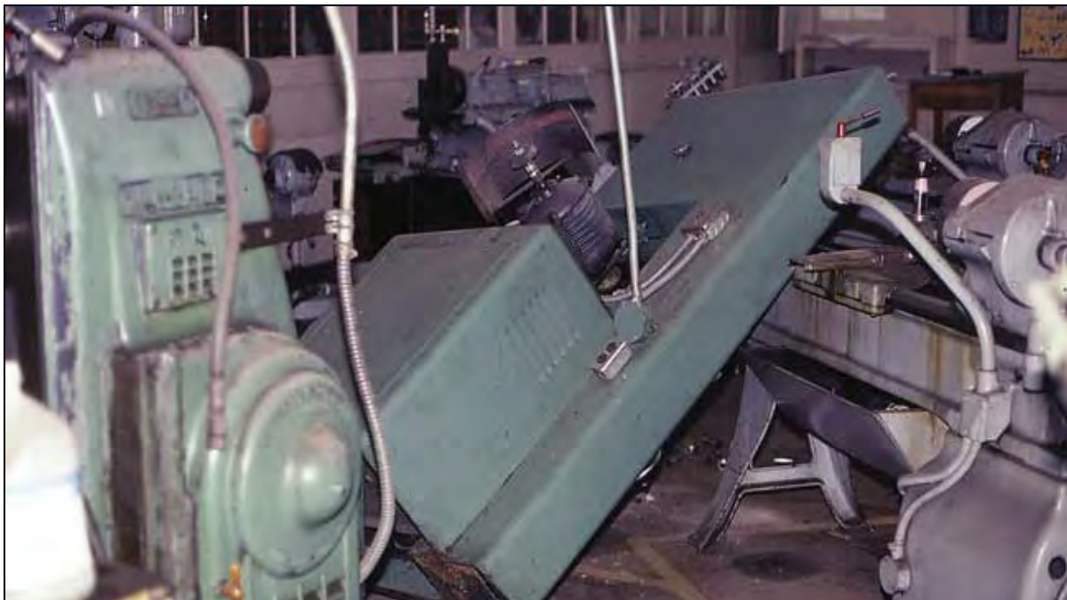
شکل ۱-۱۰- واژگونی تجهیزات سنگین در هنگام زلزله
