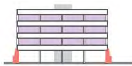
پ- اضافه کردن دیوار حائل
