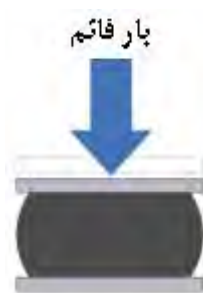
شکل ۶-۵- تغییر شکل قائم جداگر لاستیکی خالص
