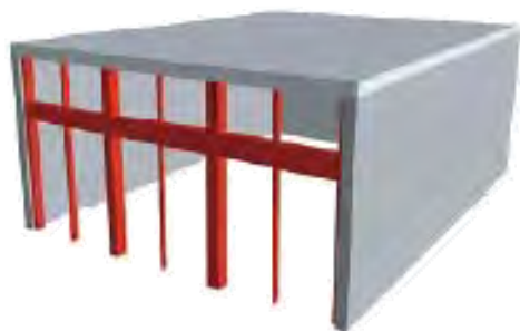
د- اضافه کردن قاب خمشی
