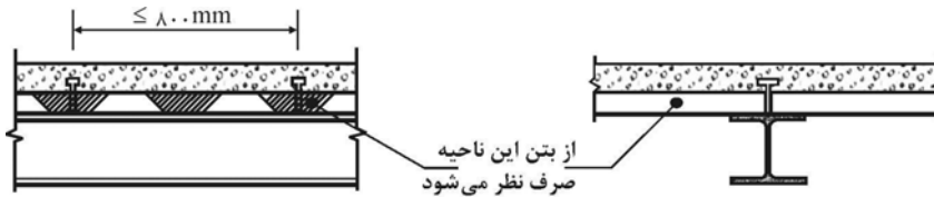
شکل ۲-۱۰-۲-۵ ورق‌های فولادی شکل داده شده که کنگره‌های آنها عمود بر محور تیر می‌باشد
