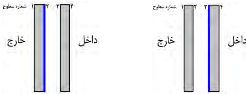
شکل 8- محل قرارگیری پوشش کم‌گسیل در مناطق سردسیر (سمت راست) و گرمسیر (سمت چپ)
