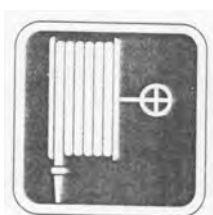
شلنگ اطفای حریق
